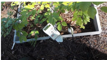
Figure 97 : mesure de l'humidité du sol avec la sonde ML3 ThetaProbe
