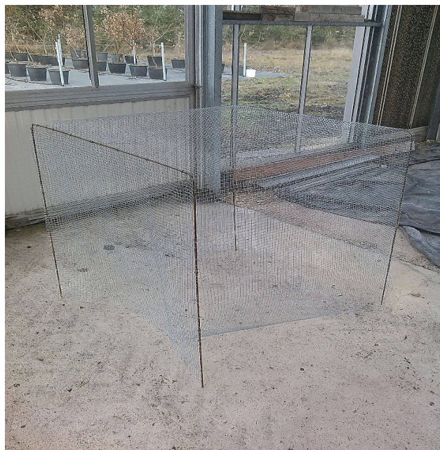
Figure 18: Photographie d'une cage de 1m 3 montée sur des cadres en fer à béton. Grillage flottant à la base pour qu'une fois les barres enfoncées dans le sol, le grillage recouvre le sol et empêche le passage de micro-mammifères.
