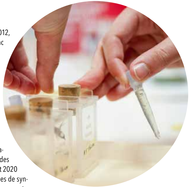
Abeilles placées en cage avec un nourrisseur contenant un sirop contaminé ou non avec une certaine quantité d'insecticide. © INRAE - C. Maître
