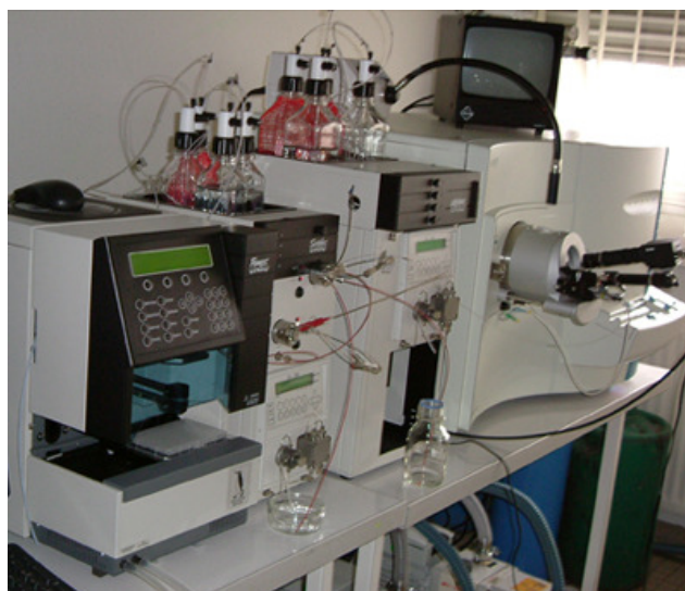
Figura 20 : De izquierda a derecha, inyector de muestra automático, bombas de HPLC y equipo de espectrometría de masas. El capilar de entrada al MS/MS se alinea con ayuda de una cámara (extremo superior derecho).
