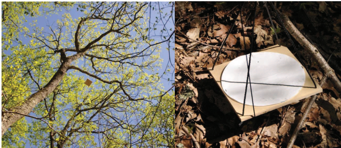
Figure 17. Piégeage des spores : filtre de papier Whatman® de 24 cm de diamètre placé sur un support horizontal en bois suspendu dans la canopée du chêne. Photographies : Xavier Capdevielle.
