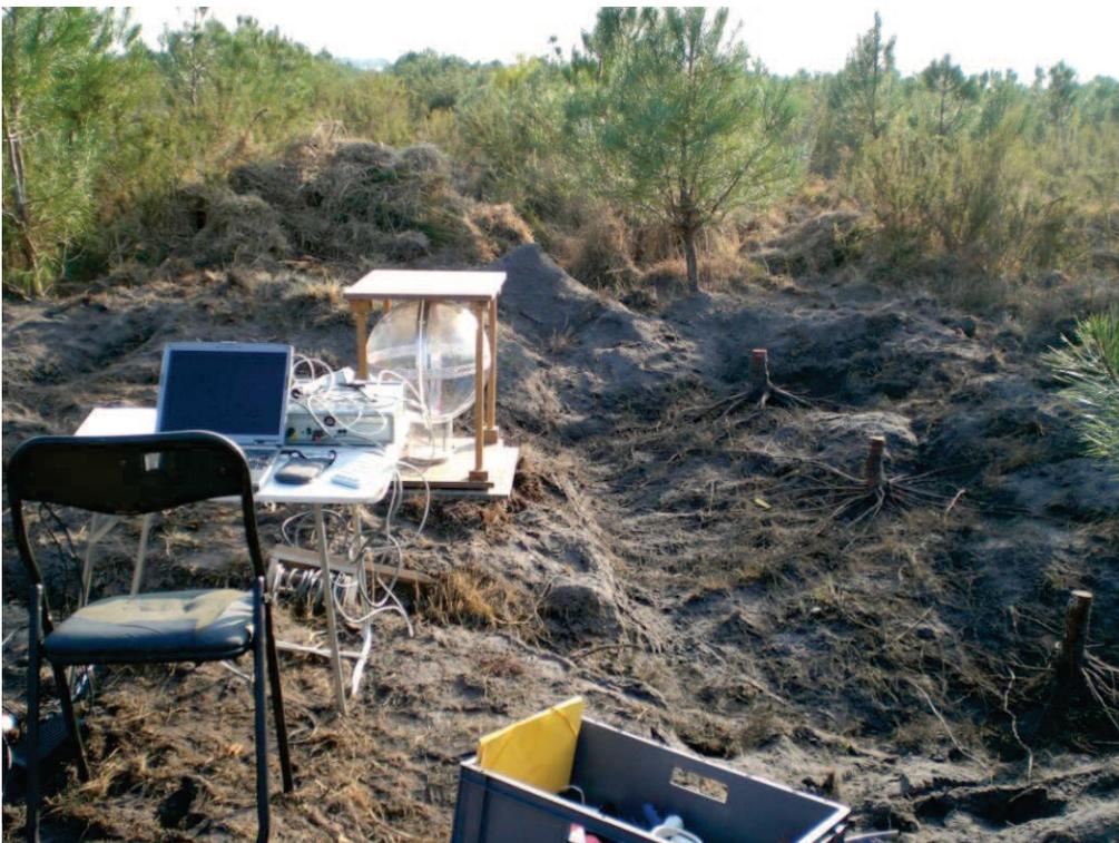
**Fig. 2** Numérisation in situ du niveau du sol, de l'altitude des racines traçantes et des pivots secondaires. Second plateau des arbres de 5 ans de St Jean d'Ilac. La partie superficielle du sol a été enlevée à la lance à air.
