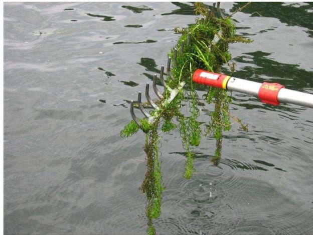
Figure 17. Râteau utilisé pour prélever les macrophytes (sur cet exemple, on prendrait le coefficient de 3).
