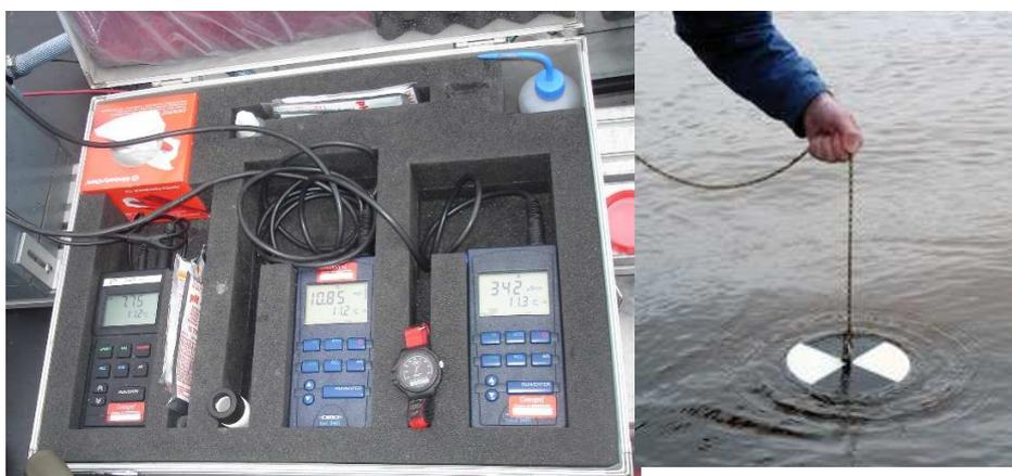
Figure 18. Sondes WTW et disque de Secchi.
