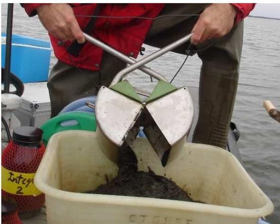
Figure 19. Benne Van Veen
