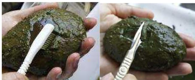
FIGURE 1.5 – Échantillonnage de biofilms diatomiques sur des galets, à l'aide d'un scalpel ou d'une brosse-à-dent.
