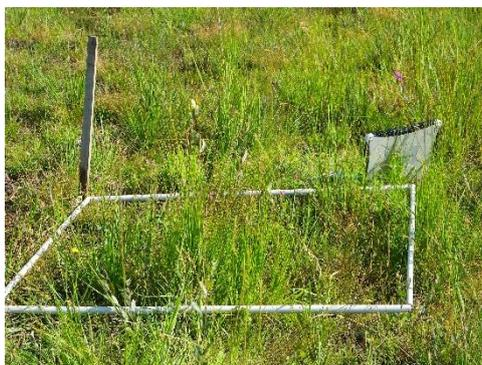
Figure 9. Représentation schématique et illustration d'un relevé et de ses cinq quadrats réalisés selon la méthode de Domin Scale
